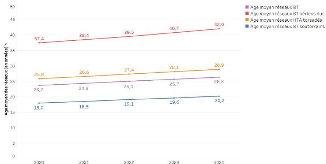
Figure 10 : Evolution de l'âge moyen des réseaux BT de la concession du Sy.MEG, par typologie de réseau
