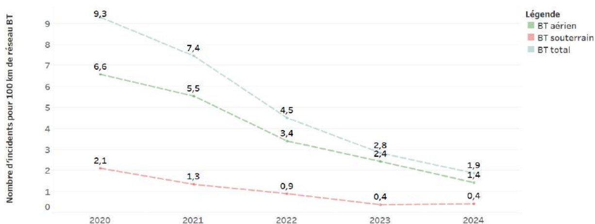
Figure 20 : Evolution du taux d'incidents BT HIX pour 100 km de réseau selon la technologie des canalisations
